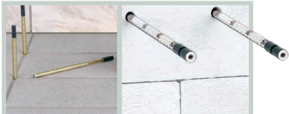
DETAIL Beide Elektrodenpaare sind mit Skalen im Ein-Zentimeter-Raster versehen
