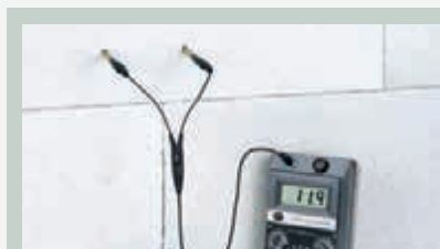
ANWENDUNG Messung mit einem Tiefen-Messelektrodenpaar M 21-250
