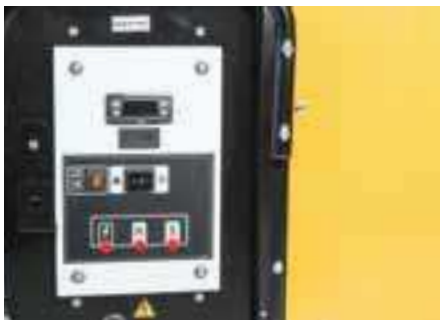
Die Verbrennung wird digital gesteuert. Ein Panel ermöglicht es, digitale Parameter einzustellen.
