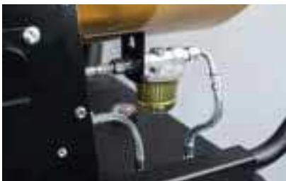
Der Kraftstoffvorwärmer ist optional, Kraftstofffilter ist außen
