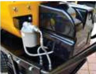
Die Heizung erhält den Kraftstoff aus dem darunter befindlichen Tank. Es kann aber auch ein externer Tank angeschlossen werden. Kraftstofffilter ist aussen, Kraftstoffvorwärmer ist innerhalb der Brennerkopfes.
