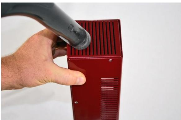
Saugen Sie von aussen angesetztem Staub ab. Verwenden Sie im Normalfall für die Aussenreinigung keine Reinigungsmittel, sondern ein trockenes fuselfreies Reinigungstuch (ohne jegliche Zusätze). Nach jedem längeren und dauerhaften Betriebseinsatz ist die Verschmutzung zu prüfen.
