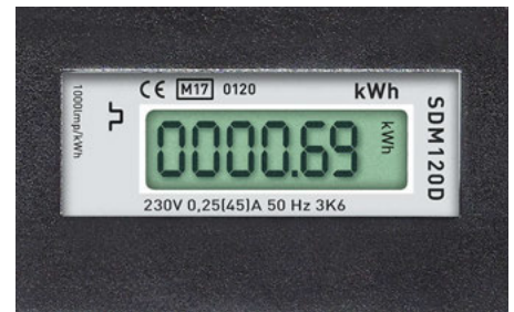
Un compteur de kilowattheures conforme à la MID 3 fait partie de l'équipement de série du Qube+.
