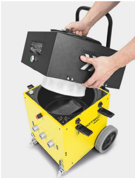
Grâce à l'absence de câble de liaison entre les deux parties de l'appareil, le couvercle du moteur peut être déposé simplement et rapidement aux fins de maintenance.
