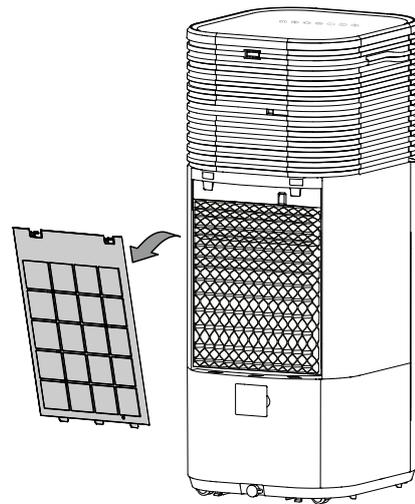
2. Pulire il filtro con un panno morbido, senza pelucchi e leggermente umido. Nel caso in cui il filtro dovesse essere molto sporco, lavarlo con acqua calda mischiata a un detergente neutro.
