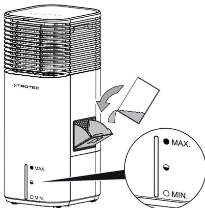
5. In caso di necessità, posizionare le piastre eutettiche nel contenitore dell'acqua (11) per ottenere un ulteriore effetto refrigerante. Le piastre eutettiche possono essere inserite in due modi diversi.
