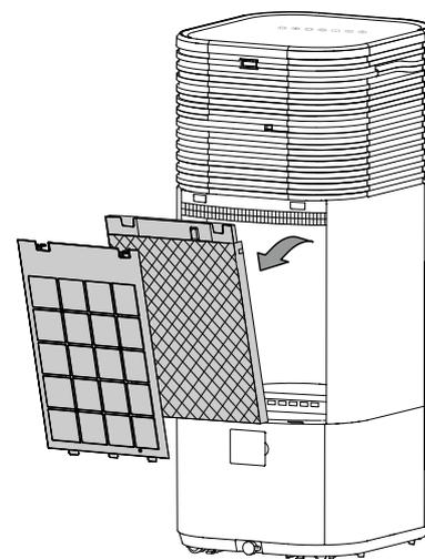
4. Rimuovere il filtro di protezione della pompa sommersa dal dispositivo. Fare attenzione a non danneggiare il filtro di protezione con le dita. Toccare il filtro solo ai lati della plastica.
