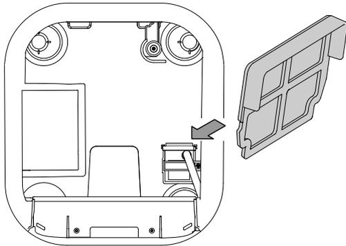
5. Pulire il filtro di protezione con un panno morbido, senza pelucchi e leggermente umido. Nel caso in cui il filtro dovesse essere molto sporco, lavarlo con acqua calda mescolata a un detergente neutro.
