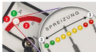
Im Gegensatz dazu ist die Optiflow-Elektronik des VE 4 MultiQube® in der Lage, die Auflösung auch kleinster Amperebereiche durch „Spreizung“ ③ des nutzbaren Bereichs deutlich zu erhöhen und selbst geringste Wertveränderungen per Signalaufbereitung über die Optiflow-LEDs von Grün bis Rot anzuzeigen.
