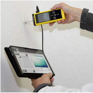
Die **LiveLog-Funktion** von MultiMeasure Studio ermöglicht eine automatische Messdatenerfassung kompatibler Geräte direkt während der Messung. Praktisch zum Beispiel bei der Matrixmessung vor Ort mit Windows-Tablet oder Laptop.
