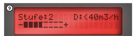
Das Optiflow-NT-Multifunktionsdisplay zeigt Ihnen farbgestützt die Aufbaueffizienz Ihrer Trocknungsinstallation an.
