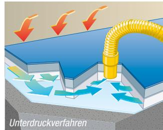
**Wichtig:** Beim Unterdruckverfahren ist der Einsatz eines Filtersystems notwendig, damit u. a. weder Wasser noch Feststoffe in den Dämmschichttrockner gelangen können. Dies würde zur Zerstörung des Gerätes führen.
