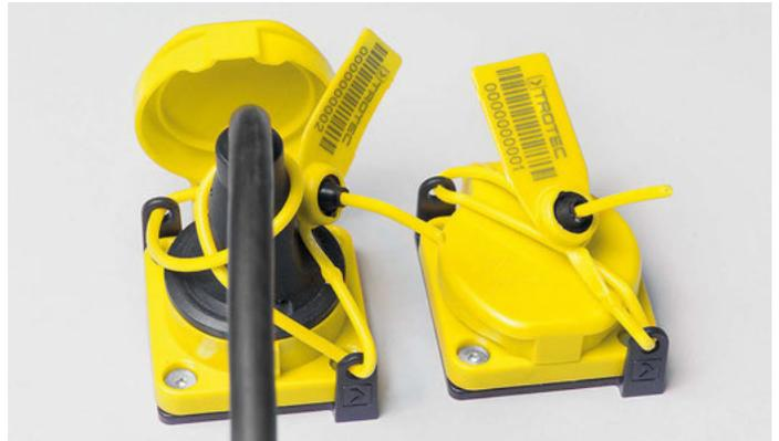
Die PlugSafe-Unterlegplatten sind für Einbausteckdosen mit Flanschbefestigung konzipiert. Zwei gegenüberliegende Lochwinkel ermöglichen die vorschriftsgemäße Sicherung der Steckdose, zum Beispiel mittels fortlaufend nummerierter Durchziehplombe. Neben der geschlossenen Steckdose ermöglicht PlugSafe auch eine Sicherung mit eingesteckten Stromverbraucher.
