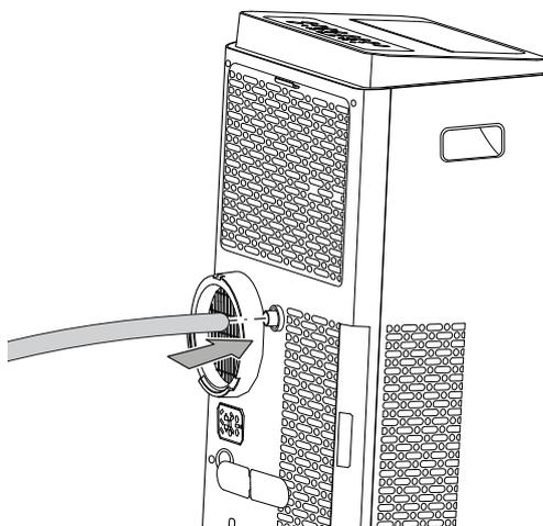
6. Portare l'altra estremità del tubo flessibile a uno scarico adatto (ad es. un pozzetto di raccolta o un contenitore di raccolta sufficientemente grande). Il tubo di scarico della condensa non deve essere piegato e non deve superare alcuna pendenza verso l'alto per arrivare allo scarico, altrimenti la condensa non può defluire.
