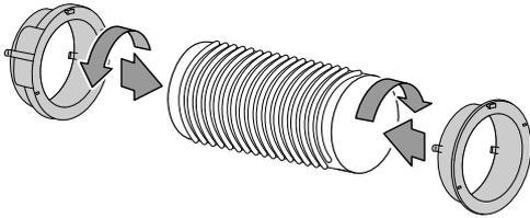
2. Collegare l'estremità adatta del tubo di scarico dell'aria con l'allaccio del tubo flessibile per lo scarico dell'aria (10) posto sul dispositivo.
