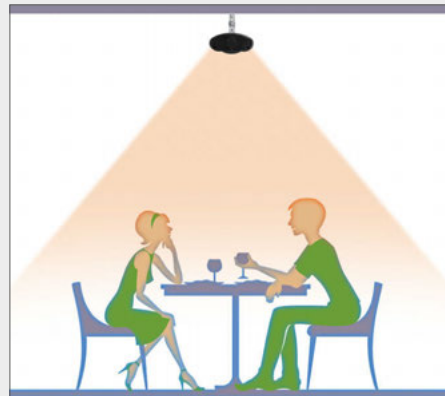
2. Je höher der Strahler hängt, desto weiter der Wärmekegel. Die Wärmeenergie ist jedoch entsprechend geringer.
