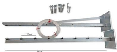
Das System wird so montiert, dass die offenen Seiten des U-Profils zur Mitte zeigen. Die Rollen sitzen auf der unteren Reihe des Profils. Die Stützen zeigen nach aussen, um den starken Seilzug zur Mitte auszugleichen.
