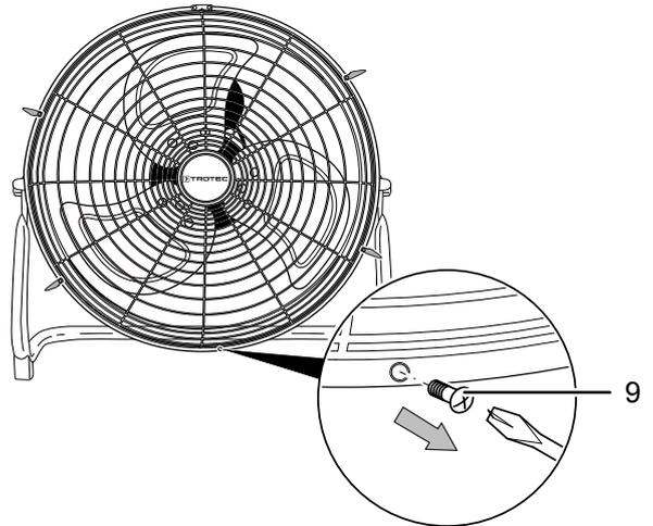
3. Per fissare nuovamente sul ventilatore la griglia di protezione dopo la pulizia, inserire la vite di collegamento (9) e riportare di nuovo i quattro fermi in posizione chiudendoli.
