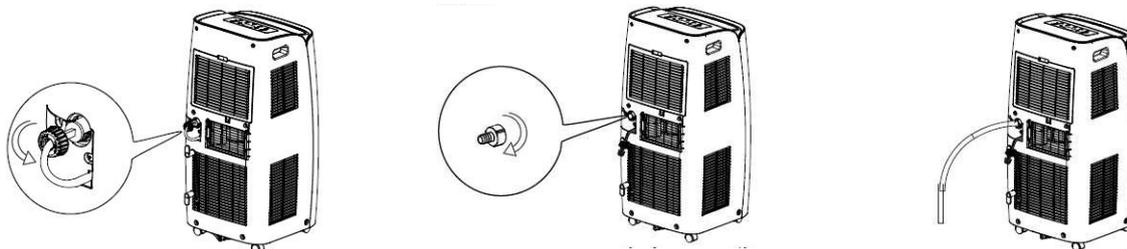
1. Retirer le capuchon en le tournant dans le sens inverse des aiguilles d'une montre puis retirer le bouchon
