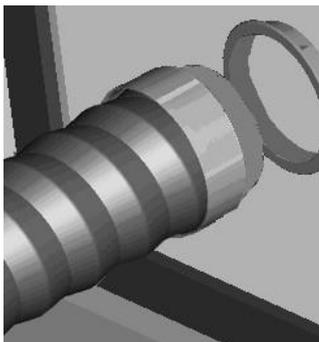
5. Insérer le raccord plat sur le tuyau flexible
