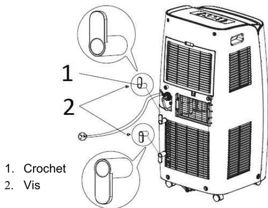
Installer les crochets d'enroulement du cordon à l'arrière de l'appareil à l'aide des vis, en respectant le sens représenté sur la figure.
