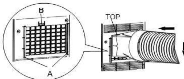
7. La hauteur d'évacuation doit se situer entre 40 cm et 130 cm du sol. Éviter que le tuyau flexible ne soit plié ou excessivement courbé.
