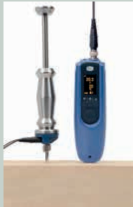
Misurazione dell'umidità in legno duro tramite elettrodo a battente M 18 e metodo resistivo (a infissione)
