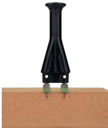
Elettrodo a infissione M 20 con dadi di fissaggio isolati, con i quali si evita che l'umidità della superficie incida sulla misurazione
