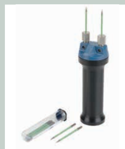
Elettrodo a inserimento M 19 con punte isolate (60 mm) per la misurazione dell'umidità nei sistemi composti d'isolamento termico a cappotto già intonacate
