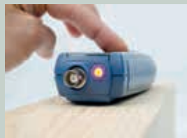
Misura non distruttiva con appoggio puntuale del sensore a forma semisferica [LED come segnale d'allarme]
