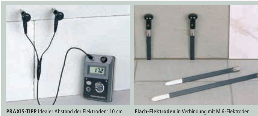
PRAXIS-TIPP Idealer Abstand der Elektroden: 10 cm
