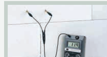
ANWENDUNG Messung mit einem Tiefen-Messelektrodenpaar M 21-250
