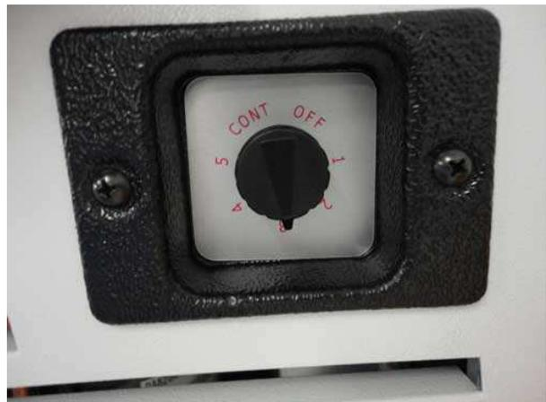
Durch Drehen des Hygrostat-Schalters oben rechts beim Luftausblas können Sie die Zielfeuchtigkeit einstellen, bis zu welcher das Gerät entfeuchten soll. Eine optimale Kellerfeuchtigkeit liegt bei ca. 50-60% Luftfeuchtigkeit, bei Wäsche ist eine Restfeuchte von ca. 40% ideal, damit Sie die Wäsche gut bügeln können.
