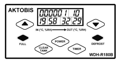
Nachdem der Bautrockner ordnungsgemäss mit der Steckdose verbunden ist, leuchtet die Hintergrundbeleuchtung des Anzeigenfeldes auf. Nach Einschalten des Gerätes (Power) leuchtet das LED-Display (Detailanzeige) automatisch auf.
