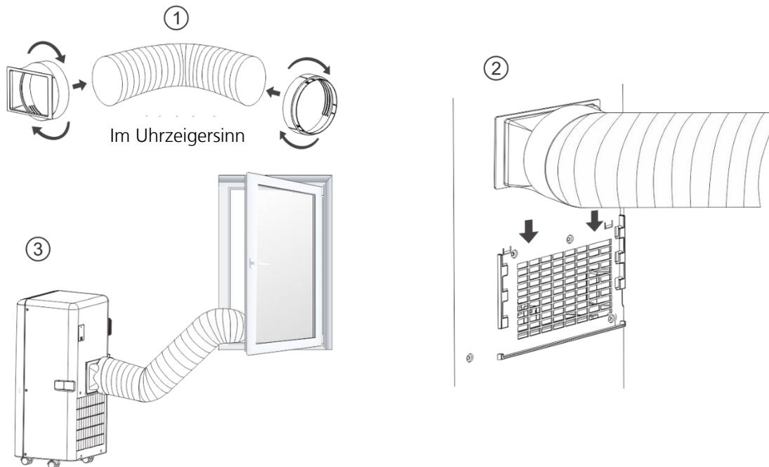
Befestigen Sie den Abluftstutzen am Abluftschlauch. (1)
