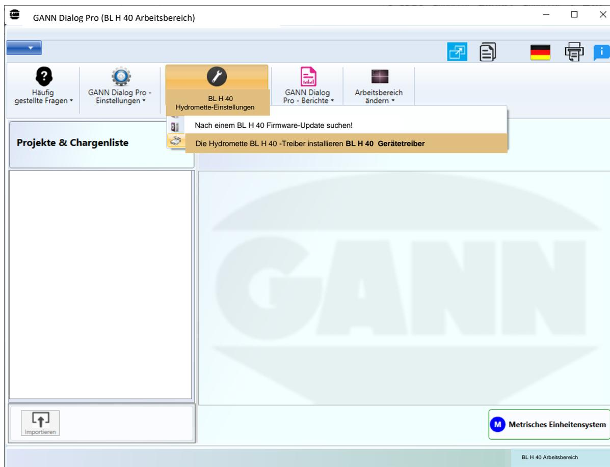
Abb\_7\_2: Gerätetreiber der Hydromette BL H 40 herunterladen
