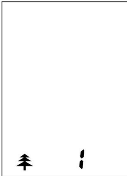
Angezeigt werden die eingestellte Materialkennzahl und das Symbol für Holzfeuchte.
