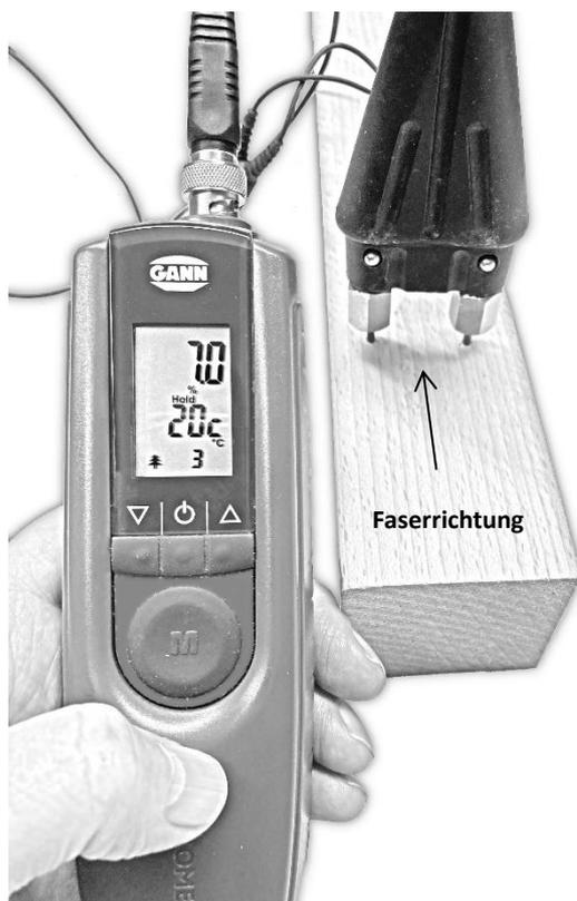
Abbildung 9-1: Holzfeuchtemessung – quer zur Faserrichtung
