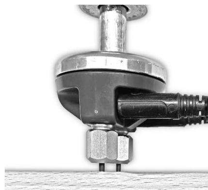
Abbildung 9-2: Verwendung teflonisierte Spitzen
