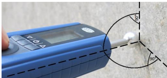
Figure 4-3 Effectuer la mesure sur une ligne imaginaire verticale par rapport à la surface d'analyse
