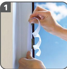
Fenster oder Tür zuerst öffnen und die zu klebenden Flächen auf dem Fensterrahmen und -flügel reinigen, so dass sie frei von Staub und Fett sind. Klettverschluss öffnen und das Klettband (**Seite A**) auf den Rahmen des Fensters oder der Tür kleben.
